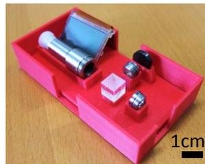
図3 3Dプリンタによる光学系模型
