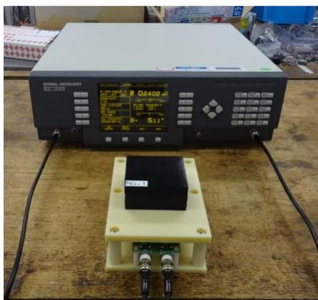
図5-2. 導電ゴムファントムおよび測定系
