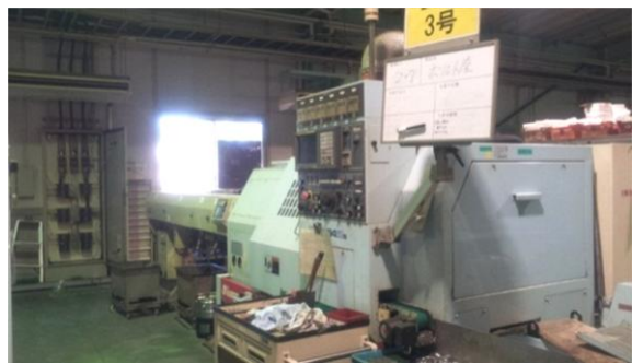
実証対象装置(NC加工機)とセンサ設置のようす
